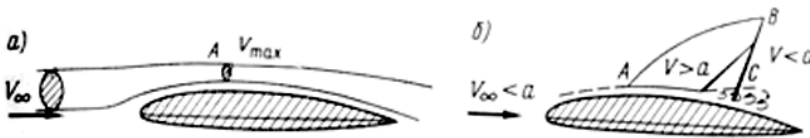
Рис. 3.9. Обтекание профиля околосвуковым потоком
