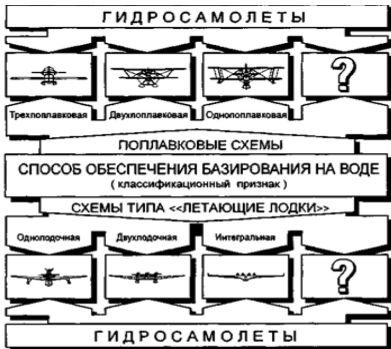
Рис. 8.10. Классификация гидросамолетов по способу обеспечения базирования на воде
