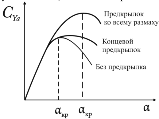
Рис 2.24. Аэродинамический эффект отклонения предкрылка
