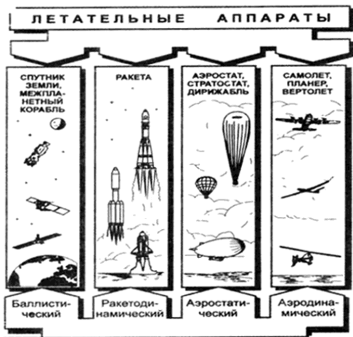
Рис. 1.2. Классификация летательных аппаратов по принципу полета
